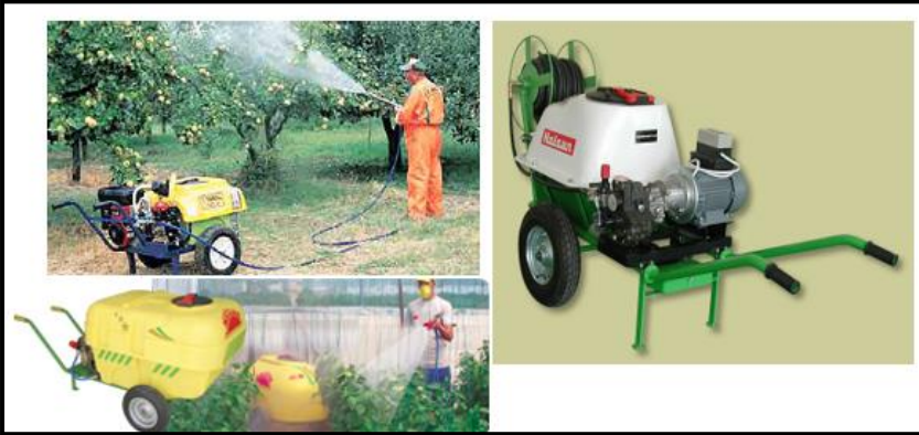
Şekil 3. Türkiye'de kullanılan yaygın motor tahrikli pülverizatör modelleri
