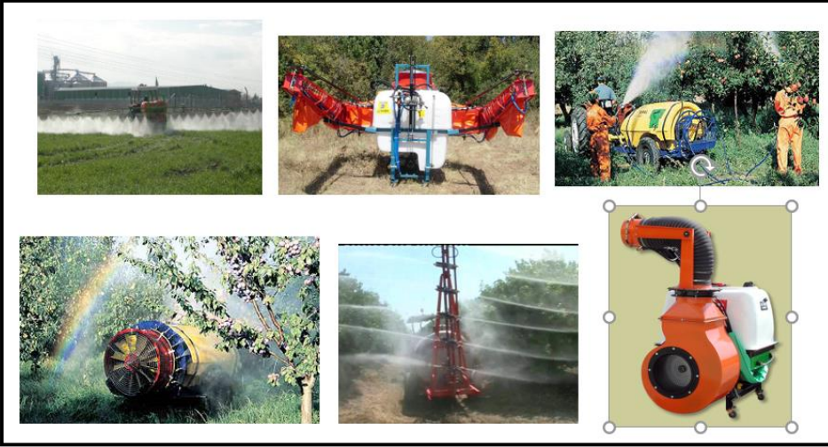
Şekil 2. Türkiye'de kullanılan PTO tahrikli püskürtücülerin yaygın modelleri
