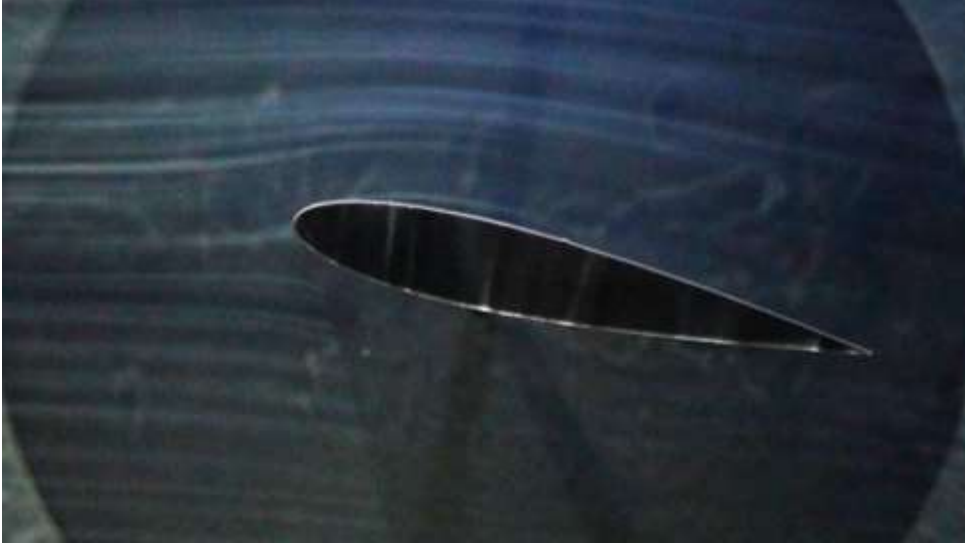
Şekil 4. Naca0015 kanat profili duman görüntüleme (Hücum Açısı 10^{\circ} )
