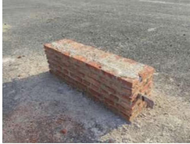
Şekil 3. Tuğla duvar deney düzeneği
