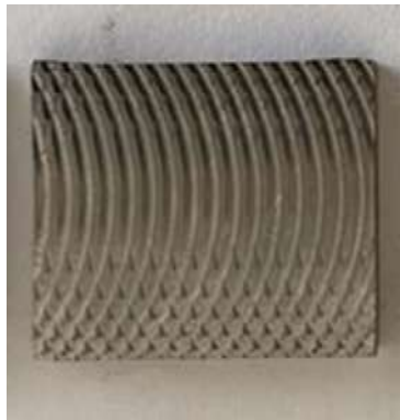
Şekil 2. S235JR frezeleme işlemi yapıldıktan sonraki görüntüsü
