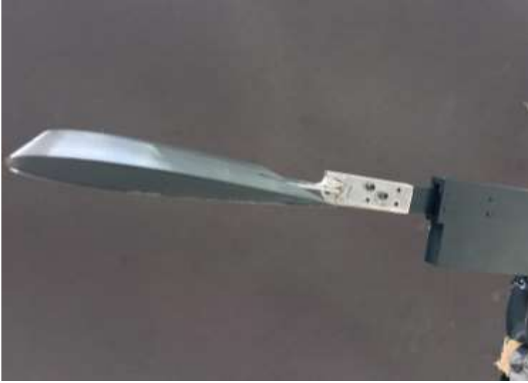
Şekil 2. Test bölümünde kuvvet ölçüm cihazına bağlı olan 3d yöntemi ile baskısı alınan Naca0015 kanat profili
