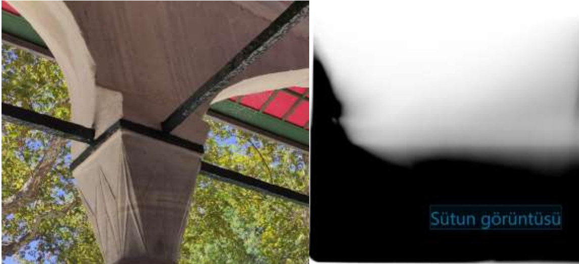
Şekil 5. Radyografi yöntemi ile teste tabi tutulan sütun başı ve radyografi görüntüsü
