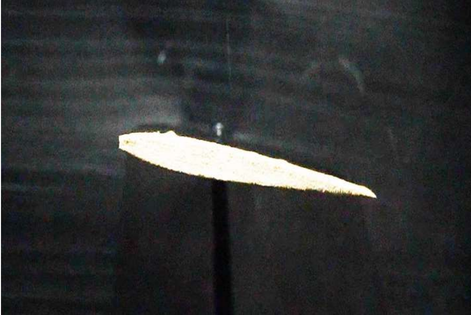
Şekil 5. Naca0008 kanat profili duman görüntüleme (Hücum Açısı 8^{\circ} )
