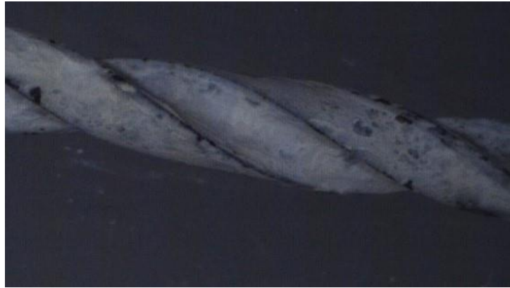
Şekil. 2. Hidroksiapatit kaplı matkap ucu
