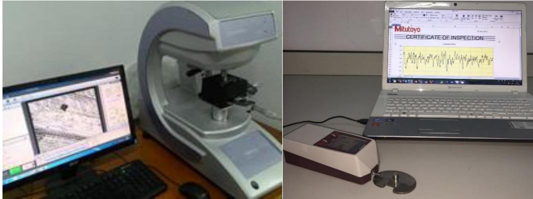
(a) (b) Şekil.2 Ölçüm yöntemleri; a) mikro sertlik, b) yüzey pürüzlülüğü
