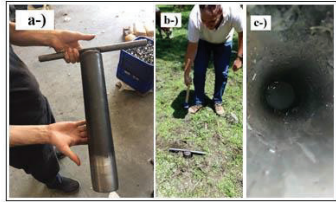
Şekil 2: Toprak altı kök örnekleme, kök alma silindirinin (a) toprağa çakılması (b) ve sonrasında döndürülerek çıkarılması (c) esasına dayanmaktadır.
