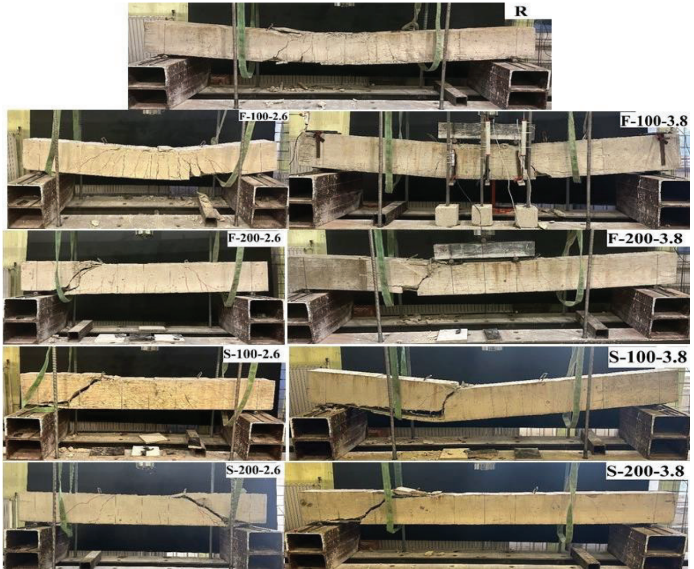
Şekil 4. Deney elemanlarına ait kırılma modları
