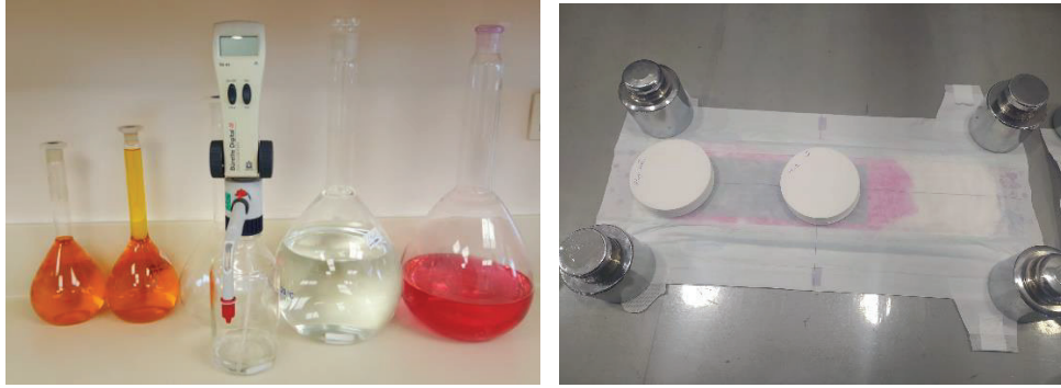
Şekil 3. Bebek bezi testinde kullanılan çözelti ve rewet test yöntemi
