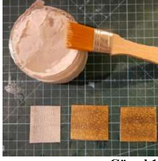
Görsel 15: Metalin Üzerine Gesso Sürülmesi.
