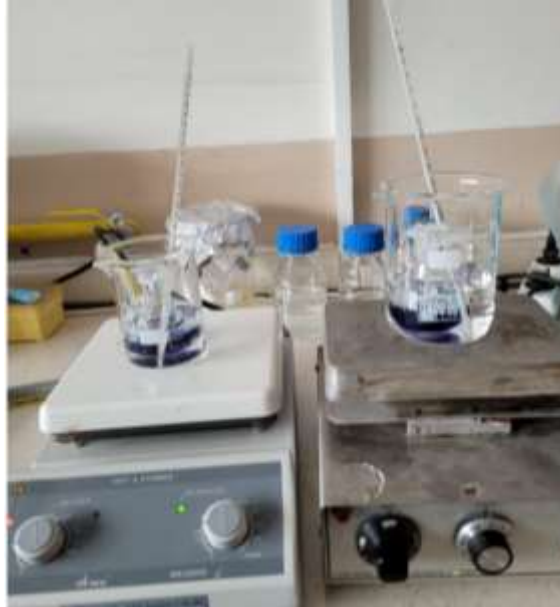
Şekil 4. Gümüş nanopartikül içeren ve içermeyen metilen mavisini çözeltilerindeki boya gideriminin araştırılması
