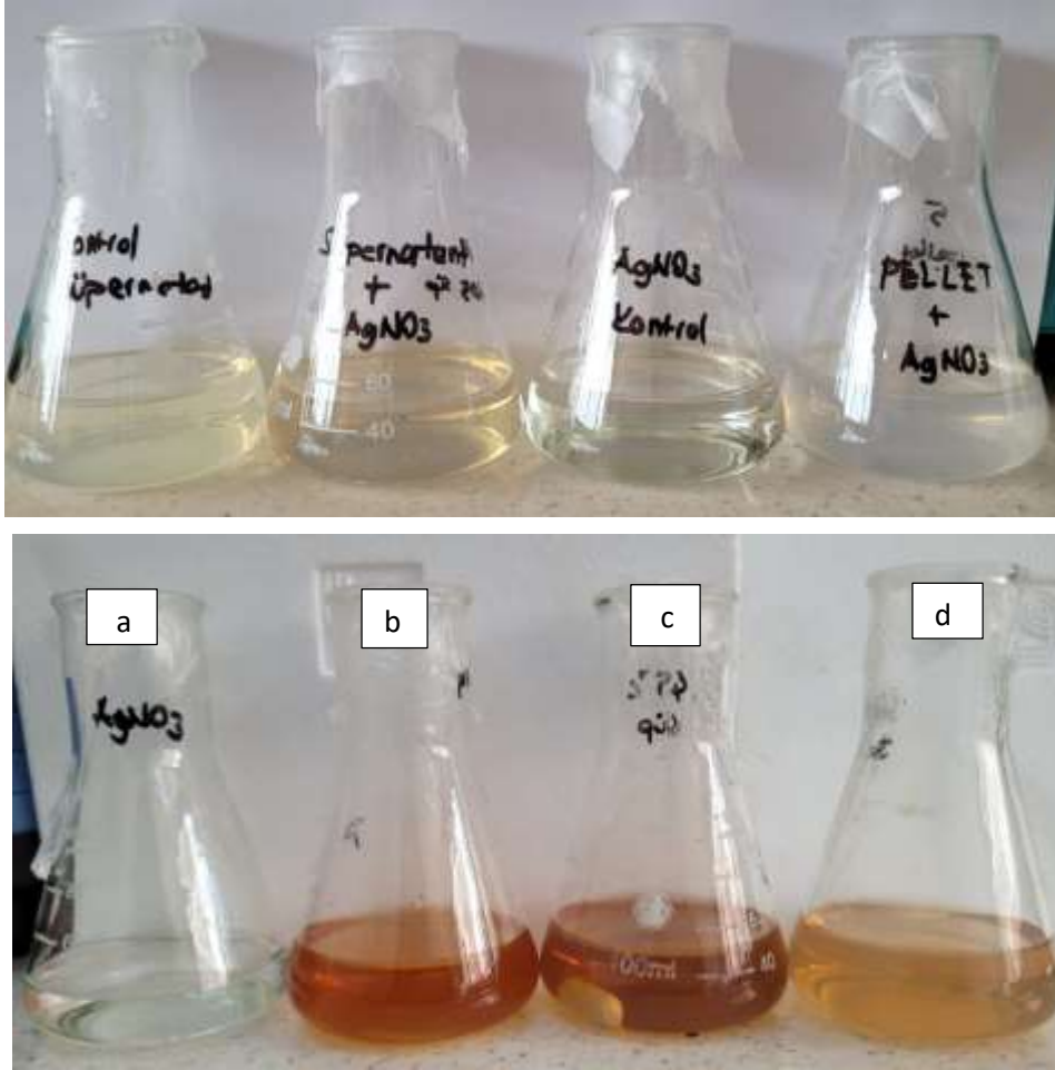
Şekil 5. Sentezlenen gümüş nanopartiküller (a: \text{AgNO}_3 b: pellet tarafından sentezlenen nanopartikül c: süpernatant tarafından sentezlenen nanopartikül d: süpernatant kontrolü: \text{AgNO}_3 + \text{LB} )
