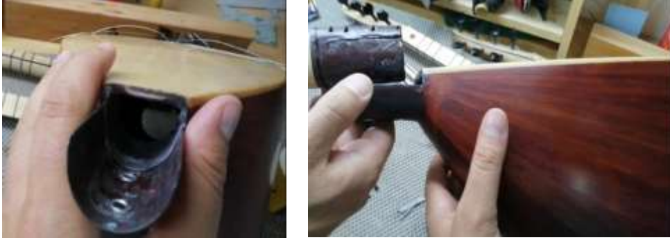
Şekil 2. Teknenin sap tarafına yerleştirilen “U” şeklindeki metal aparat (Öztorun, 2022)
