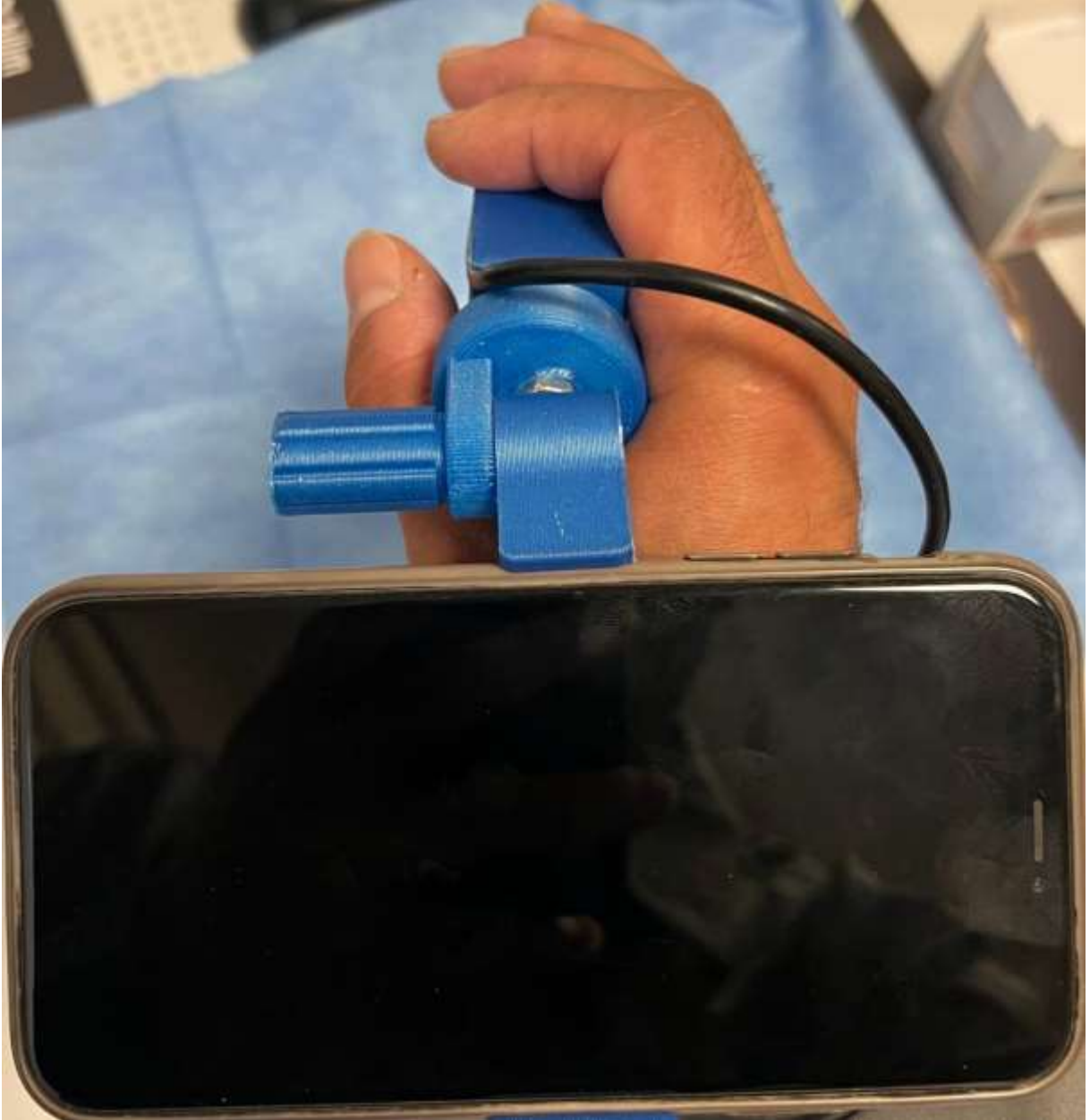
Resim 3: Reverse Laringoskop Prototipi video ünitesi; yerleşik bir cep telefonu ve buna bağlı kablo kameradan oluşmaktadır
