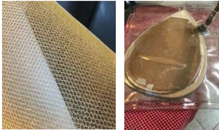
Şekil 8. Kompozit malzemeyle kaplanan ses tahtası (Çıkrıkçıoğlu, 2021)
