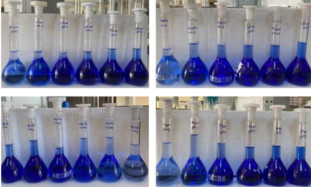
Resim 2 pH=3,5,7 ve 9 için hazırlanmış 10, 20, 30, 40, 50 ve 60 ppm'lik reaktif mavi 19 boyarmaddesi çözeltileri
