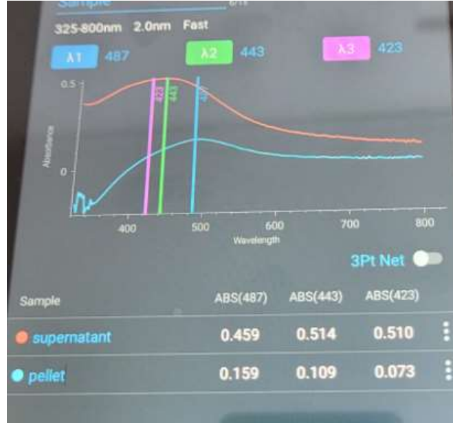
Şekil 6. Bakteri pellet ve süpernatantının sentezlediği gümüş nanopartiküllerin 325-800 nm dalga boyundaki pikleri
