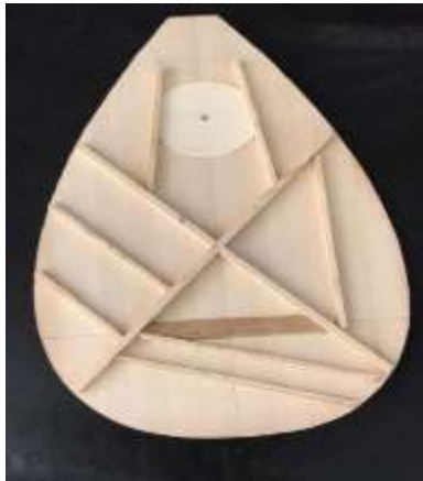
Şekil 5. Ses tahtasına eklenen balkon sistemi ve ses deliğinin konumu (Güdek, 2019)
